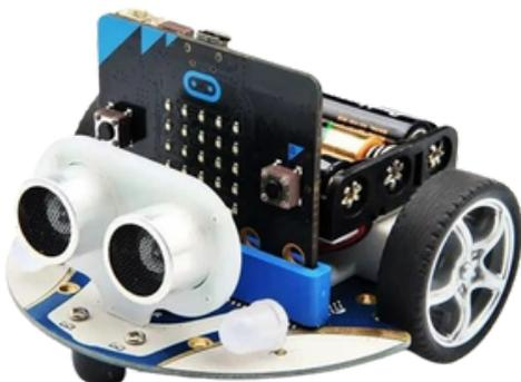
Es un vehículo preparado para realizar un montón de actividades de robótica móvil gracias al sensor de seguimiento de línea y al sensor de distancia. Programable con placa micro:bit y ampliable con otros componentes electrónicos, cámaras de visión artificial y baterías recargables.
