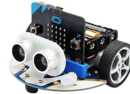
Es un vehículo preparado para realizar un montón de actividades de robótica móvil gracias al sensor de seguimiento de línea y al sensor de distancia. Programable con placa micro:bit y ampliable con otros componentes electrónicos, cámaras de visión artificial y baterías recargables.
